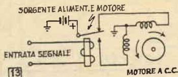
**13** Circuito a relay unico per il comando di un motore elettrico (marcia avanti e marcia indietro).
