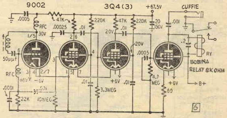
L'uso di una 9002 come rivelatrice a super-reazione permette circuiti di una maggiore sensibilità.
