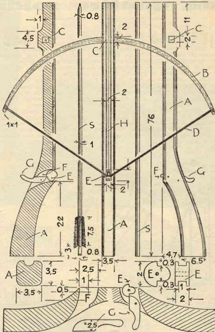
Il dente di ritegno è fatto di legno duro di 2 centimetri di spessore, portato alle dimensioni date nei diversi particolari e imperniato nell'interno della mortasa F, illustrata nei nostri disegni.
