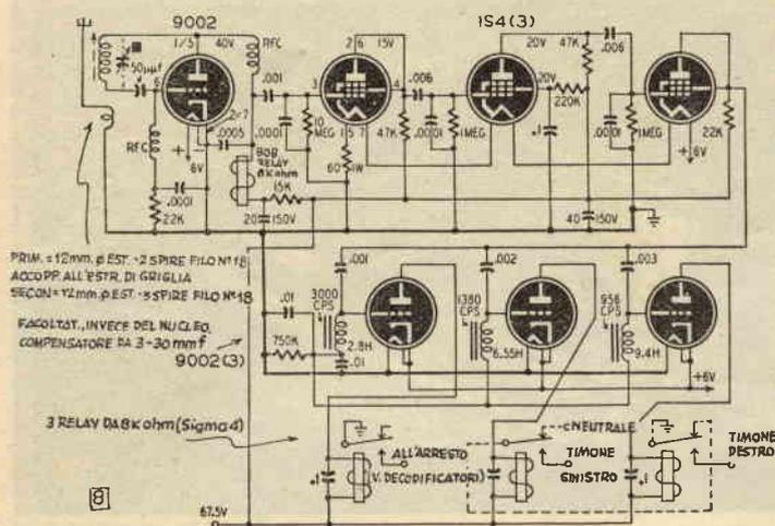
Ricevitore a tre filtri e tre valvole relay. E' un circuito per modellisti esigenti.
