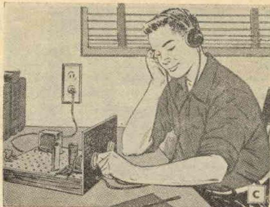
piamento resistivo. L'alimentazione all'apparecchio avviene attraverso un trasformatore di potenza tipo booster per TV ed un raddrizzatore al selenio. L'uso del trasformatore di potenza isola la linea di alimentazione dal circuito del ricevitore, rendendo così più sicuro lavorare su questo che su tutti i comuni apparecchi a corrente alternata e continua.
