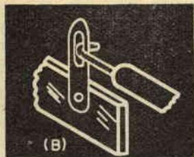
**I TRE TIPI di connessioni meccaniche usate in radiotecnica:** (A) per giunti permanenti; (B) per giunti eventualmente da disfare; (C) per giunti provvisori.
