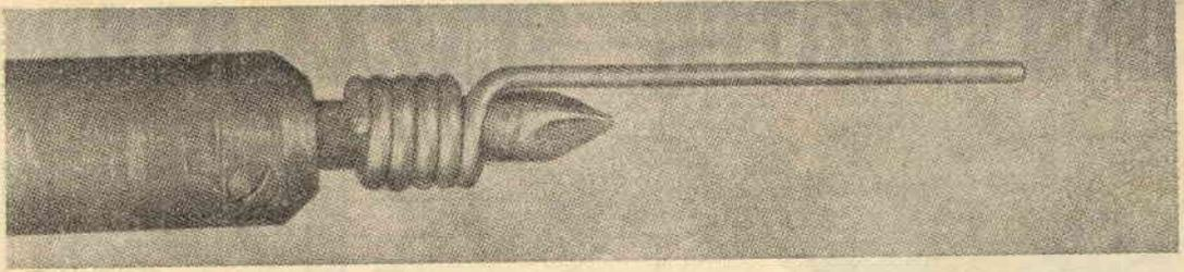
**UN PEZZO DI GROSSO** filo di rame può permettere di eseguire saldature laddove non è possibile arrivare con la testa del ferro.
