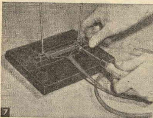
AI TERMINALI dell'antenna va collegato un corto pezzo di piattina da 300 ohms. L'altra estremità del quale va poi collegata ai terminali dell'apparecchio.
