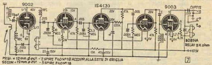
Ricevitore con filtro nel circuito di griglia della rivelatrice.
