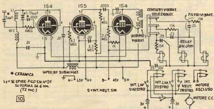
Ricevitore usante come decodificatore tre aste vibranti. Le bobine delle aste costituiscono il carico della placca della IS4.
