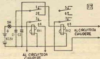
**17** Catena di relay con due relay.
