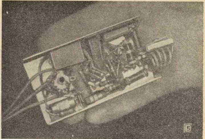
I collegamenti sul retro del telaio del ricevitore trivalvolare di fig. 4.
