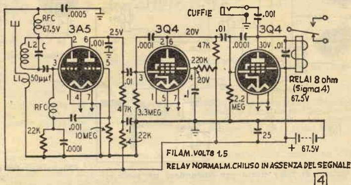
Ricevitore trivalvolare: usate una rivelatrice in super-reazione.
